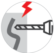
Механическое повреждение изоляции
