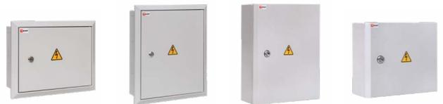
Предназначены для размещения различного модульного оборудования. Конструкция щитов предусматривает защиту от контакта с токопроводящими элементами, электрощиты оснащены съемной фальш-панелью. Электрощиты изготовлены из российской стали, соответствующей ГОСТ 1050-88, имеют сварной конструктив, что обеспечивает их высокую жесткость и герметичность соединения частей.
