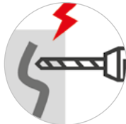
Механическое повреждение изоляции
