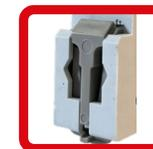
✓ **Двухпозиционный зажим** обеспечивает удобную установку на DIN-рейку. Специальная выемка позволяет, при необходимости, снять аппарат крестовой отверткой, которой обычно работают электрики, присоединяя проводники.
