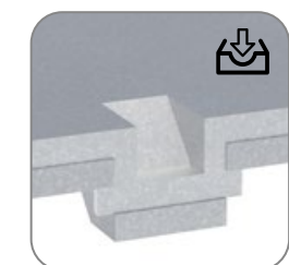
Клинчинг - надежный метод соединения лонжерона и поперечины
