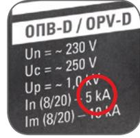
**Номинальный разрядный ток  $I_n$**  – пиковое значение тока, протекающего через УЗИП, с формой волны 8/20 мкс.
