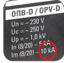
**Максимальный разрядный ток  $I_{max}$**  – пиковое значение тока, протекающего через УЗИП, имеющего форму волны 8/20 мкс и величину согласно испытательному циклу в рабочем режиме испытаний класса II.
