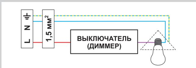
На рисунке показан выключатель с пружинными клеммами. Зелено-желтую жилу подсоедините к клемме заземления светильника (люстры). Если такая клемма отсутствует, то просто заизолируйте конец провода в светильнике.
