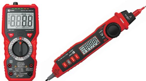
**Мультиметр цифровой.** Используется для измерения основных параметров сети — силы тока, напряжения, сопротивления, а также для проверки наличия напряжения в бытовой розетке или работоспособности лампочки, для
