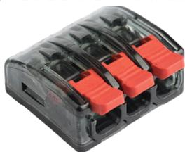
При использовании безвинтовых клемм дополнительного обслуживания не потребуется, поскольку специальная пружина плотно прижимает жилу к контактной части клеммы. Процесс установки займет меньше времени благодаря фиксации с помощью специального рычажка, а не винтов. К безвинтовым клеммам также можно подключить как жесткие, так и гибкие провода.
