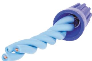
Зачищенные концы проводников вставляются в пружину, после чего нужно закрутить зажим на несколько оборотов. Корпус СИЗ будет закрывать оголенные части проводов, одновременно являясь изоляцией для соединения. Плюсы от использования СИЗ: надежность и быстрота монтажа.
