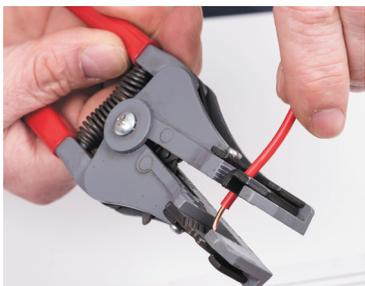
Ручной полуавтоматический стриппер снабжен двумя парами губок с лезвиями. Конец кабеля помещается в рабочую зону инструмента, и при смыкании ручек лезвия надрезают изоляцию, а губки снимают ее с жилы. Регулируемый упор позволяет точно регулировать длину оголяемого участка провода.
