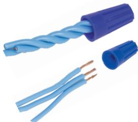
Выбирать СИЗ нужно по количеству подсоединяемых проводов и их сечению. При соединении нескольких жил сечением от  $1,5 \text{ мм}^2$  стоит скрутить их вместе при помощи плоскогубцев и уже после этого фиксировать соединение в СИЗ.
