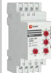
Многофункциональное реле контроля фаз RKF-8 EKF PROxima является микропроцессорным устройством, применяется в системах автоматизации и предназначено для контроля качества напряжения сети в электроустановках до 1000 В переменного тока трехфазной сети. Реле имеет информативную светодиодную индикацию и регулировочные винты на лицевой панели для установки необходимых пользовательских диапазонов.
