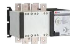
Устройство АВР ТСП1 EKF PRPxima предназначено для обеспечения резервным электроснабжением нагрузки, подключенной к системе электроснабжения, имеющей основной и резервный вводы. Устройство АВР автоматически подключает резервную линию питания в случае пропадания напряжения на основной линии.
