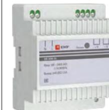
Блок питания 24В DR EKF PROxima предназначен для питания стабилизированным напряжением постоянного тока 24 В различных радиоэлектронных устройств. Блок является импульсным преобразователем напряжения с защитой от перегрузки, перегрева и короткого замыкания на выходе.
