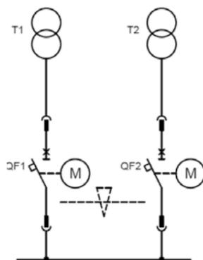
В данной схеме присутствуют два ввода: основной и резервный. Оба ввода подключены к одной секции, к которой подключена и нагрузка.
