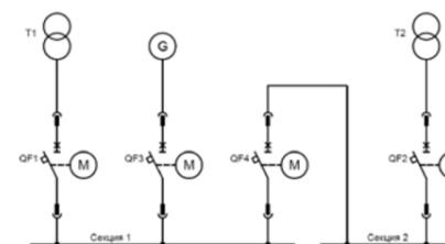
В этой схеме питание осуществляется так же, как и в схеме «два рабочих ввода с секционированием». Главным отличием схемы является присутствие третьего ввода от ДГУ.
