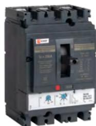
Основание выполнено из термостойкой пластмассы, не поддерживающей горение и являющейся несущей конструкцией для присоединительных зажимов. Блок ротоактивных контактов с двумя дугогасительными камерами представляет собой жесткую сборку в отдельном корпусе. Устройство оснащено механизмом управления, блоком защиты от сверхтоков и перегрузки (расцепителем). Крышка закрывает все подвижные элементы механизма управления и внутренние токоведущие части.
