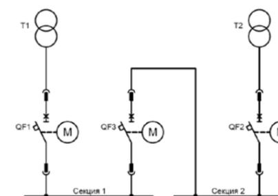
Данная схема предполагает питание от двух вводов, каждый из которых подключен к отдельной секции. Соединение двух секций осуществляется с помощью секционного выключателя.
