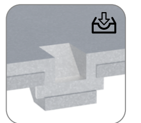
Клиннинг - надежный метод соединения лонжерона и поперечины
