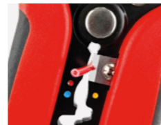
ЗАМЕНЯЕМОЕ ЛЕЗВИЕ ДЛЯ РЕЗКИ ПРОВОДОВ
