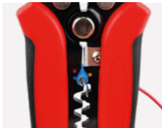
ОПРЕССОВКА ИЗОЛИРОВАННЫХ И НЕИЗОЛИРОВАННЫХ НАКОНЕЧНИКОВ
