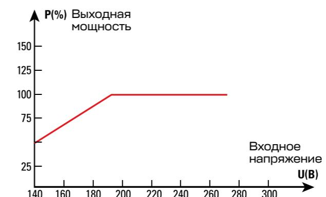
Если входное напряжение находится в диапазоне 190-250 В, стабилизатор может обеспечивать 100% максимальной выходной мощности, указанной в спецификации. Максимальная выходная мощность будет изменяться в соответствии с кривой на рисунке.
