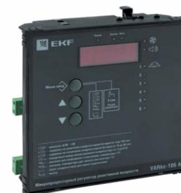
Измеряют коэффициент мощности сети и управляют включением косинусных конденсаторов для удержания оптимального коэффициента мощности. Регуляторы КРМ применяются в автоматических регулируемых устройствах компенсации реактивной мощности для автоматического контроля и увеличения коэффициента мощности электрической сети.
