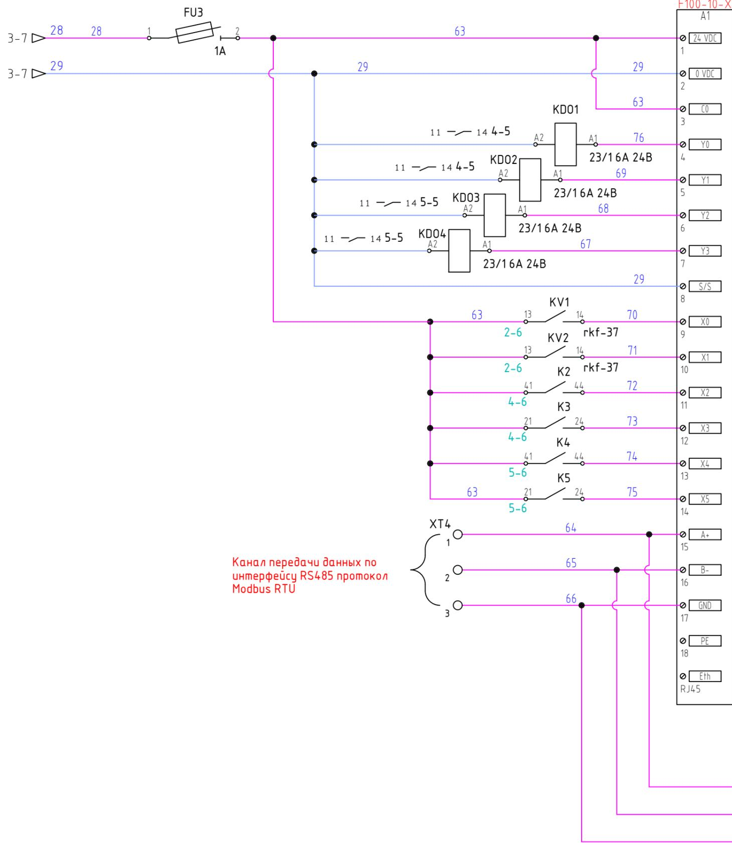
Канал передачи данных по интерфейсу RS485 протокол Modbus RTU
