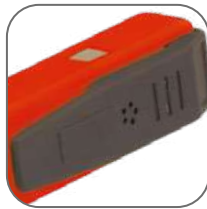
Звуковая индикация в дополнение световой (ОИ-2э)
