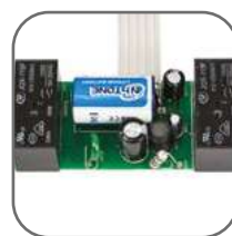
Два встроенных реле на токи до 16 А
