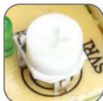
Возможность корректировки выходного напряжения
