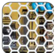
Вентиляционные отверстия для луч- шего теплоотвода
