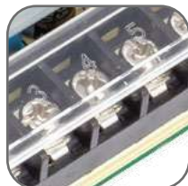
Сдвоенные клеммы питания для удобного подключения
