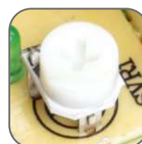
Возможность корректировки выходного напряжения
