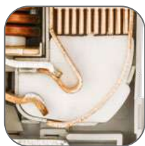
Рабочая зона закрыта диэлектриком
