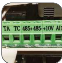
Встроенный интерфейс RS485
