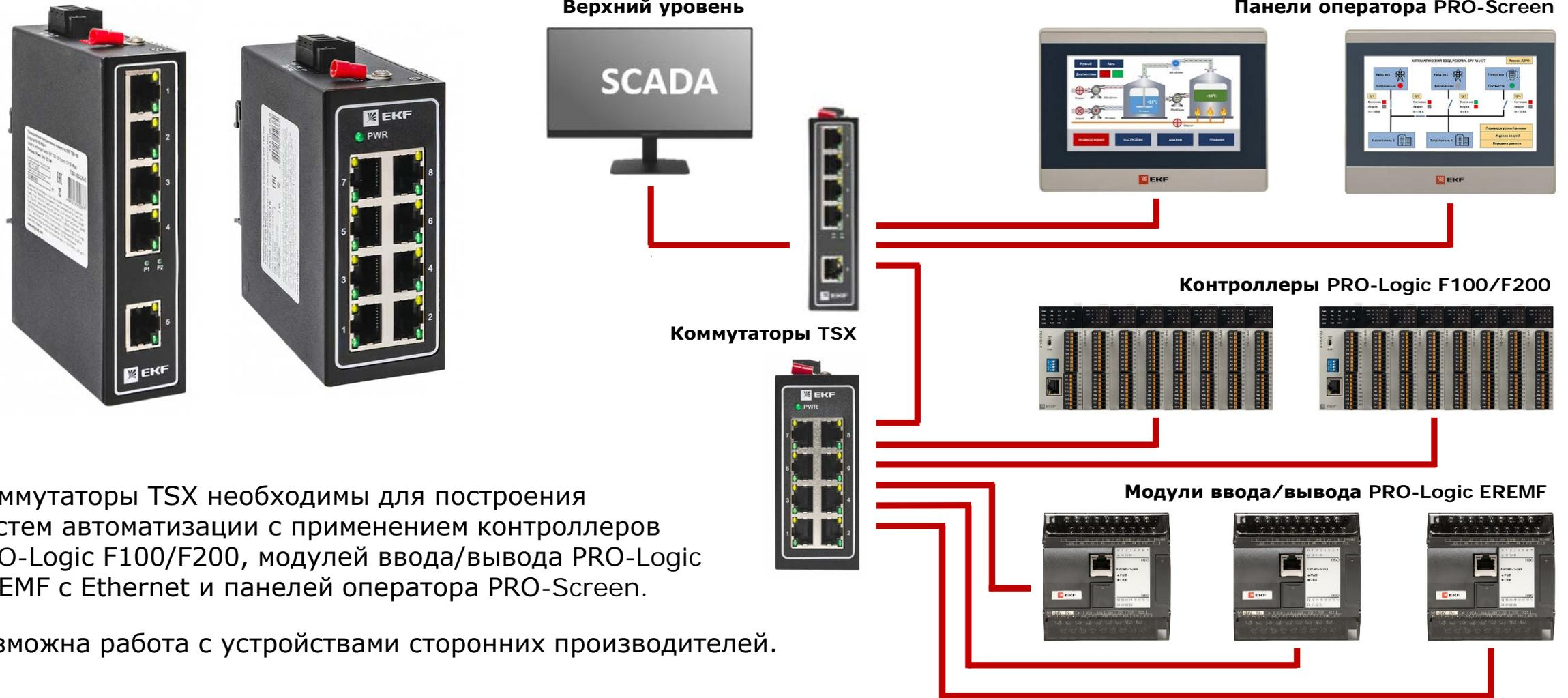
Коммутаторы TSX необходимы для построения систем автоматизации с применением контроллеров PRO-Logic F100/F200, модулей ввода/вывода PRO-Logic EREMF с Ethernet и панелей оператора PRO-Screen.
