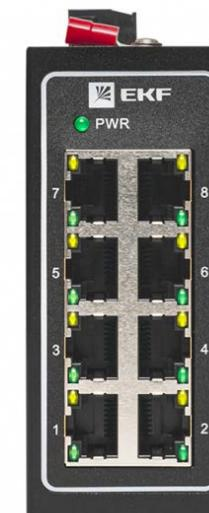
Устройства предназначены для создания промышленных сетей Ethernet второго уровня (L2)
