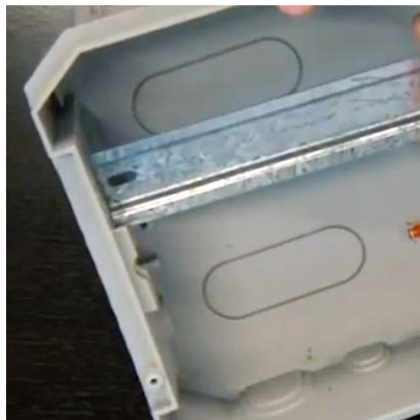
Шаг 2 Открутить саморезы и высвободить DIN-рейку
