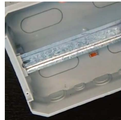
Шаг 3 Установить DIN-рейку в паз
