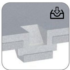
Клиннинг - надежный метод соединения лонжерона и поперечины
