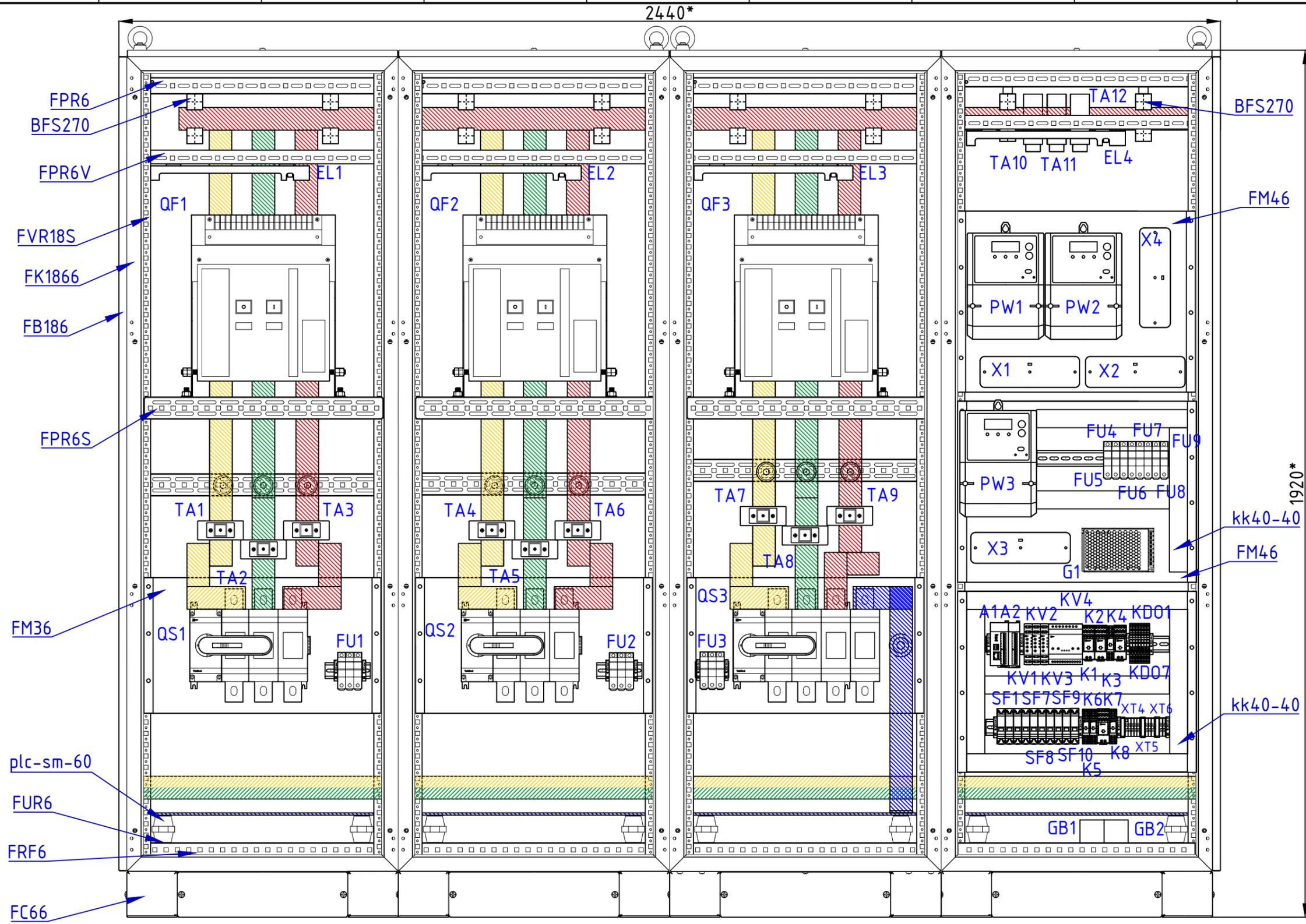
Автоматика ввода резервного электропитания, три ввода (основной, резервный и ДГУ) на общую секцию, выключатель ВА-45, 800 А, исполнение шкафы FORT IP31. Вид спереди без дверей.
