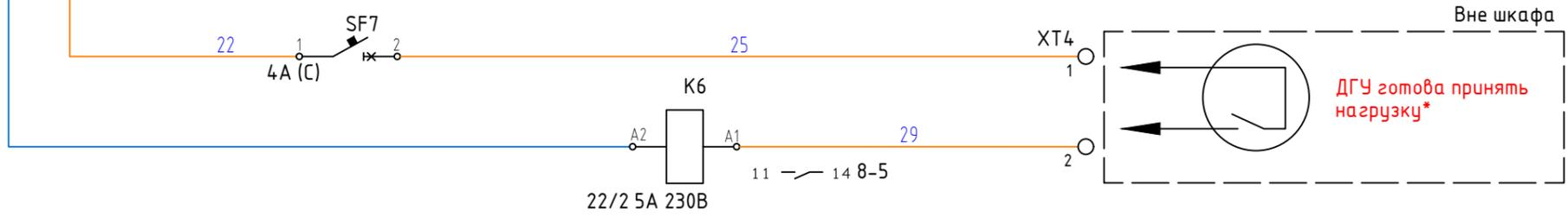
\*При отсутствии данного функционала установить перемычку на клеммы XT4:1 и XT4:2
