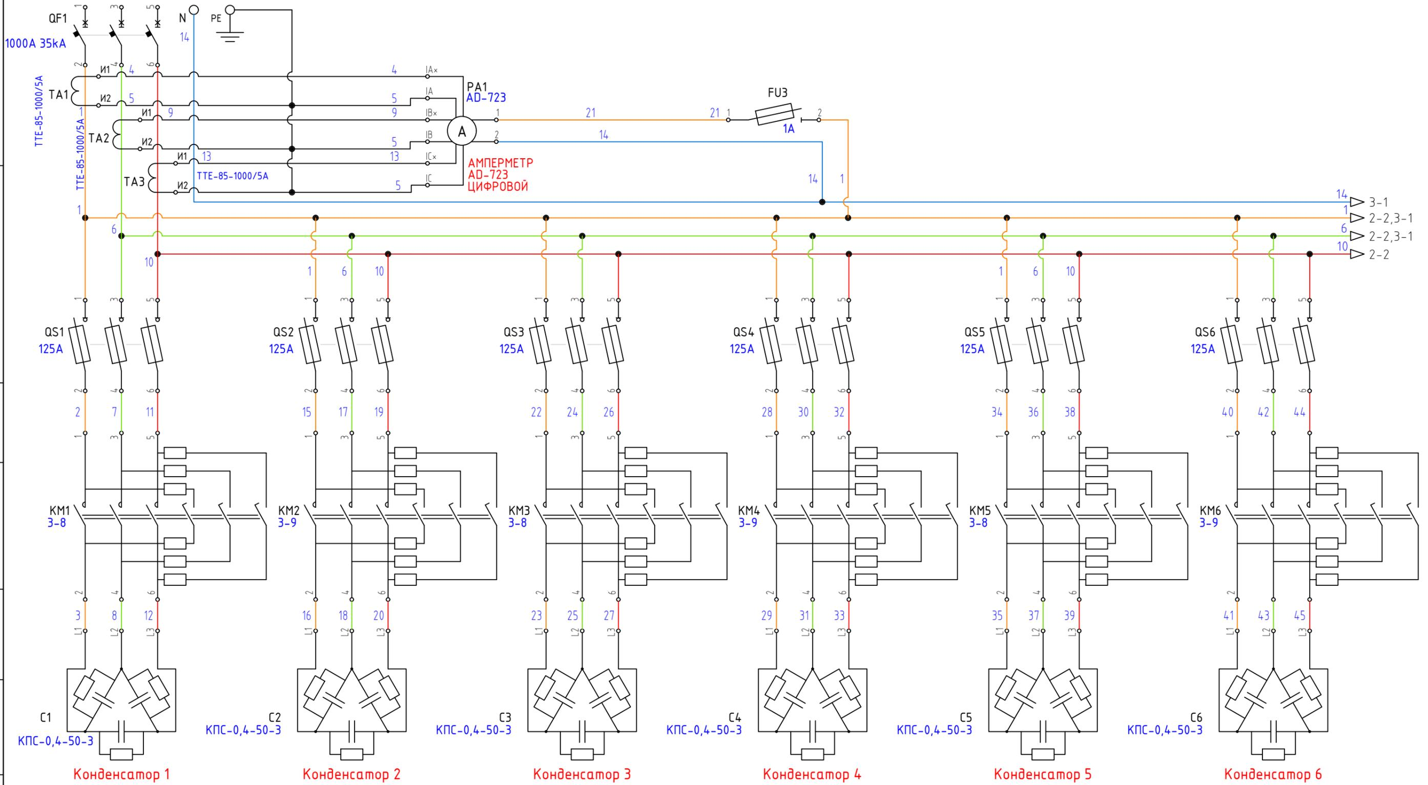
Установка компенсации реактивной мощности - "укрм-0,4-400-50-рго".
