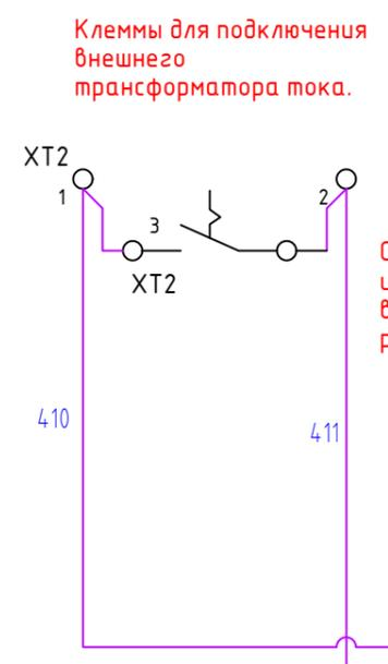
Клеммы для подключения внешнего трансформатора тока.
