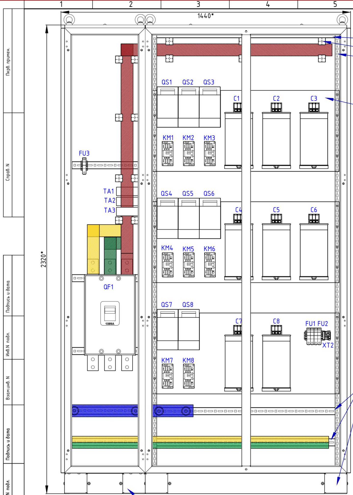
Установка компенсации реактивной мощности, УКРМ 400/50, укрт-0,4-400-50-рго.
