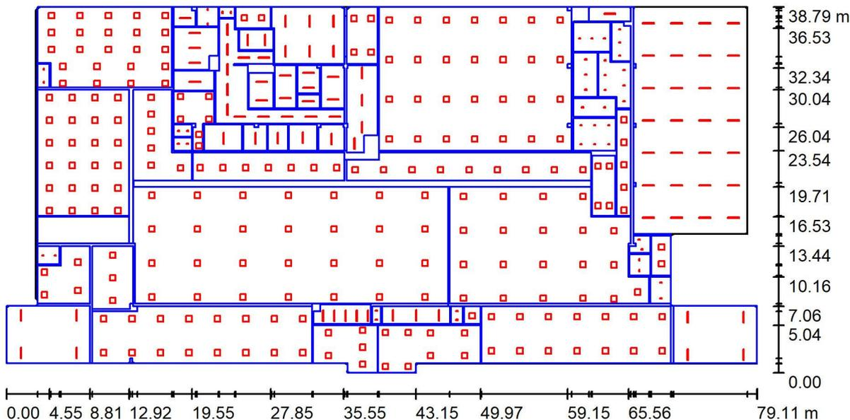
Высота помещения: 6.000 m, Коэффициент эксплуатации: 0.75
