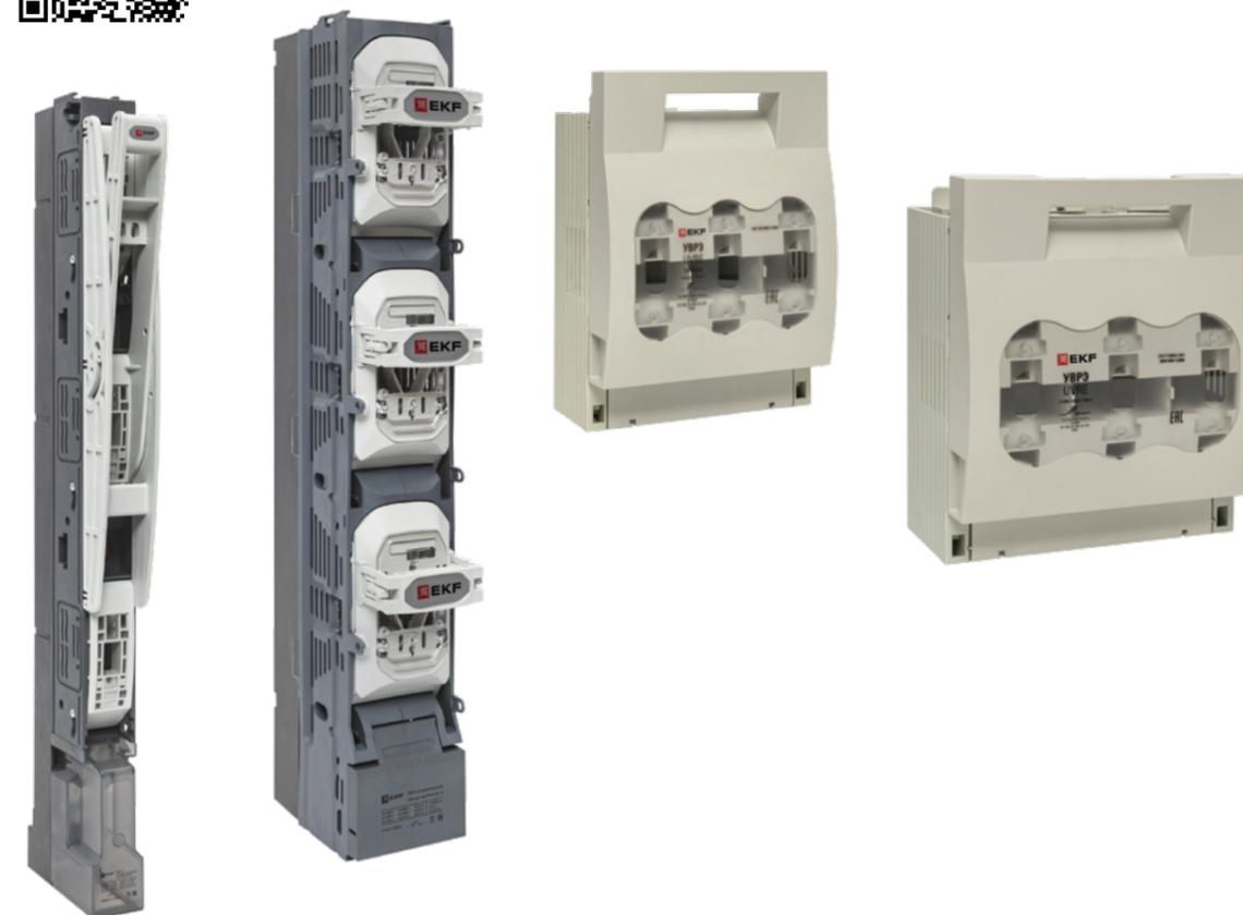
Выключатели-разъединители УВРЭ EKF предназначены для применения в низковольтных электрических сетях переменного тока. Служат для неавтоматических операций включения и отключения токов нагрузки в номинальном режиме, а также для защиты от коротких замыканий и перегрузки благодаря использованию с плавкими предохранителями типа ППН.
