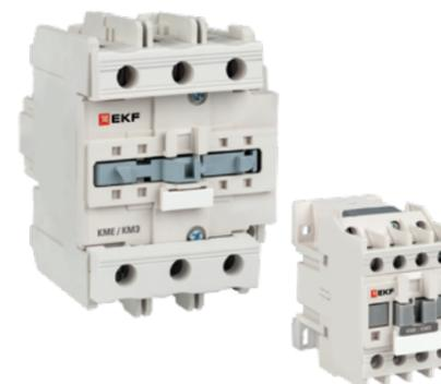
Предназначенные для двигателей с короткозамкнутым ротором: пуск, отключение без предварительной остановки в сети переменного тока (категория применения AC-3) и для неиндуктивных или слабоиндуктивных нагрузок, печей сопротивления (категория применения AC-1).
